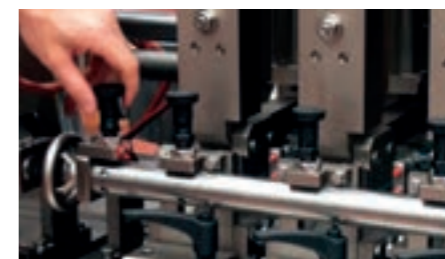
Les changements rapides de format réduisent le temps et la perte de matériau.
