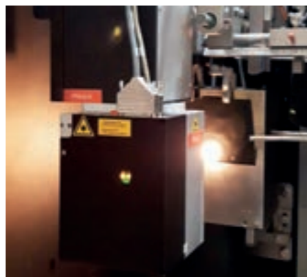
L'utilisation de la coupe au laser réduit la maintenance et le matériau de film d'au moins 3%
