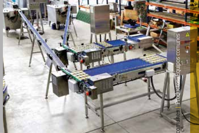
Système de déchargement des grilles Sistema de desemparrillado
