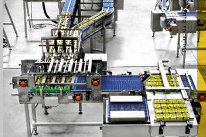
Système de chargement des grilles Sistema de emparrillado
